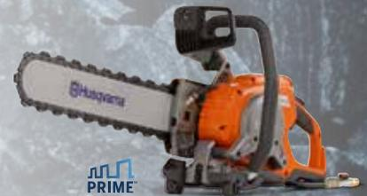
**HUSQVARNA K 7000 RING** Kraftvoller, gut ausgewogener 5,5-kW-Elektrotrennschleifer mit Hochfrequenz-PRIME™ Technologie, die hohe Schneidgeschwindigkeiten ermöglicht. Die 425-mm-Ringtrennscheibe ermöglicht Schnitttiefen von 325 mm.
